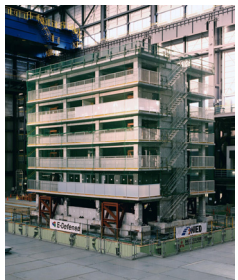
図8 実大モデル実験用震動台(E-Defense)
