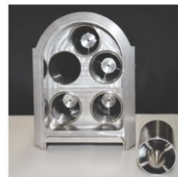
J-Parc水銀ターゲット用マイクロバブル発生ユニット (マイクロバブル発生ノズルは微細気泡を生成できるが圧力損失が大きく、さらに管路内では微粒化効率が低下する。これらの問題点は、低抵抗並列ノズル(スタティックミキサー)を使用することにより解決され、J-Parcで運用されている。)
